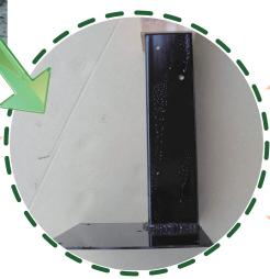
3.2mm×200mm×200mm の鉄 板に 2.3mm×75mm×75mm の 角パイを溶接し、黒塗装を施し た超高耐久 & 超高剛性な金具で す
